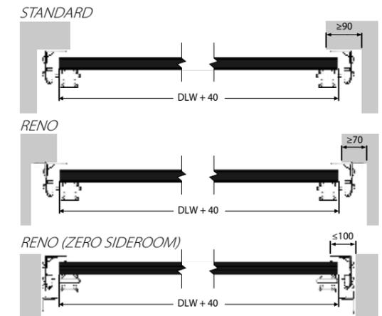
\* bei einem Sturz von über 360 mm, Montage mit Hilfe von Winkelprofilen welche bestellt werden müssen.
